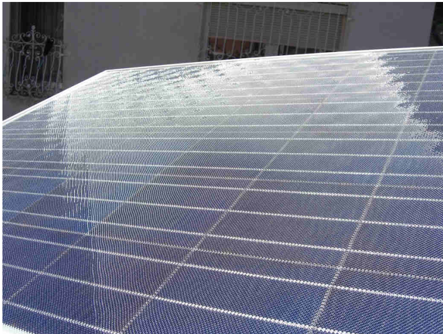
steiler Einstrahlwinkel, steiler Blickwinkel, maximale Reflexleuchtdichte ca. 20.000 cd/m 2
