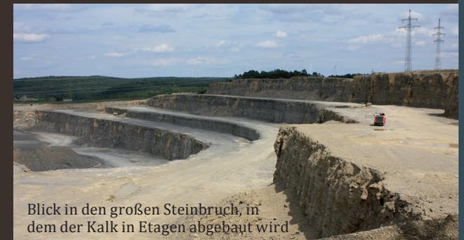
Blick in den großen Steinbruch, in dem der Kalk in Etagen abgebaut wird
