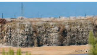
So wird der Kalkstein vom Berg getrennt: Breite Wandabschnitte werden durch Sprengstoff entfernt. Der Kalkstein kommt zum Brecher zum Zerkleinern (unteres Foto).
